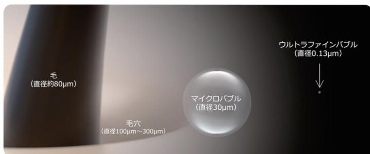
ウルトラファインバブル(直径1 $\mu$ m未満の泡の事)は、人間の眼では見えないほど微小な泡。ISOで定められた国際標準規格でマイクロバブルよりさらに小さく、モノとモノのすき間に入り込む特性のため、さまざまな洗浄に利用されています。
